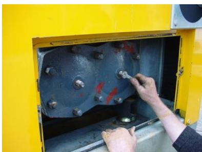
После снятия накладных гаек крышка насоса может быть снята, и станут видны прижимные корзины.
