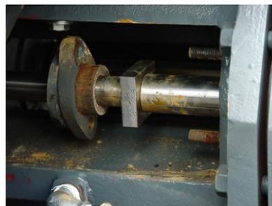
После того как втулка поршневого штока встанет в корпус, можно вдавить сальник в нужное место. Для этого переместите инструмент (из швеллерной стали) и нажимное устройство для уплотнений вперед. После этого снова установите инструмент на квадратную часть.
