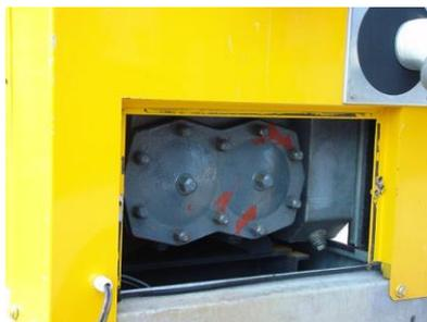
Открутите 2 накладные гайки. Затем следует открутить показавшиеся регулировочные винты (85) как минимум на три оборота.
