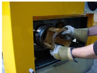
При монтаже нового поршня надежно закрутите гайку и закрепите контргайку.
