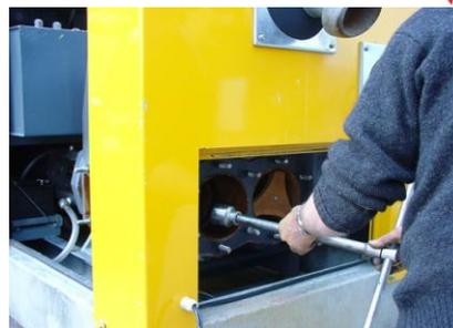
Поверните поршневой шток при помощи клиноременного шкива назад таким образом, чтобы манжета осталась стоять вместе с пластиной. При необходимости заблокируйте манжету и пластину, например, разместив между манжетой и втулкой цилиндра отвертку.
