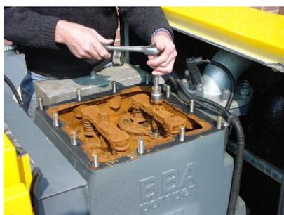
Завинтив винт М16 х 70 полностью с резьбой в резьбовое отверстие можно снять седло напорного клапана. Кроме того можно применять инструмент для съема клапанов в качестве вспомогательного средства, с помощью которого можно снимать всасывающие клапаны.
