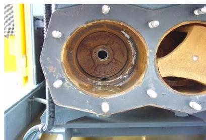
Выньте манжетную пластину и манжеты из гнезда. После снятия центровочной пластины и самой задней манжеты можно увидеть вторую манжетную опору.
