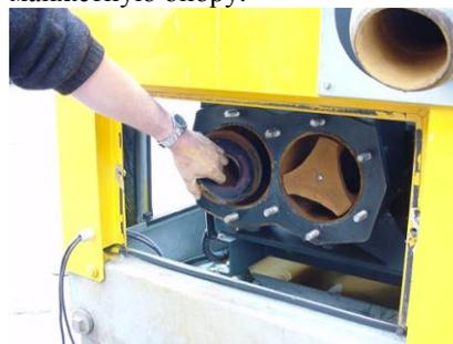
Вторая опора для манжет установлена с помощью резьбового соединения на поршневой шток. Обычно эту опору снимать не нужно.
