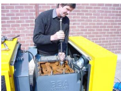
В то время как вес инструмента перемещается вверх, клапан вместе с седлом можно выбить из корпуса насоса.
