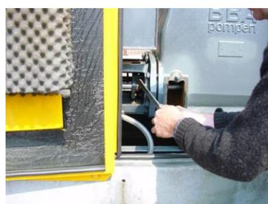
Переместите поршень при помощи клиноременного шкива рукой вперед в направлении напорного отверстия. Через очистное отверстие установите инструмент (получашу) на шток поршня за манжетной опорой.
