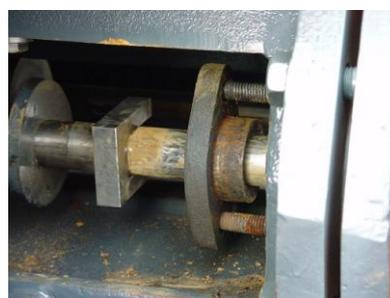
Вдавите уплотнительное кольцо рукой в корпус насоса, для этого переместите поршень вперед. Повторите данные действия, пока не будут установлены все уплотнительные кольца. При установке последующих все ранее установленные кольца необходимо каждый раз поворачивать на 90°.
