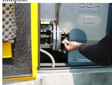
Теперь передвиньте поршень рукой при помощи клиноременного шкива в направлении картера привода.
